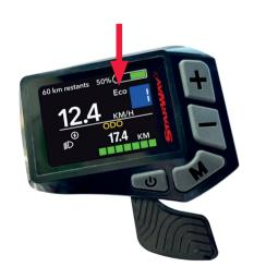
Le mode Equi-Motion gère automatiquement les 5 niveaux d'assistance. Le booster vous offre une réserve permanente de puissance
