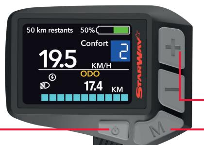
Ce pictogramme indique que l'éclairage automatique est activé. Il peut être activé ou arrêté avec un appui de 3 secondes sur la touche -
